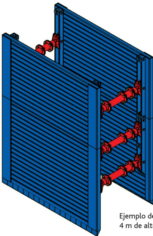
Ejemplo de Entibación de 3 m de largo y 4 m de alto con diferentes alargadores.
